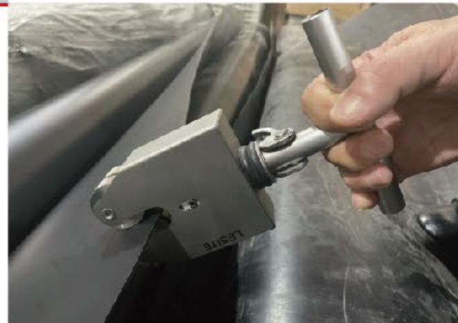
HDPE 1.5mm Geomembrane LST-PULLER 1
